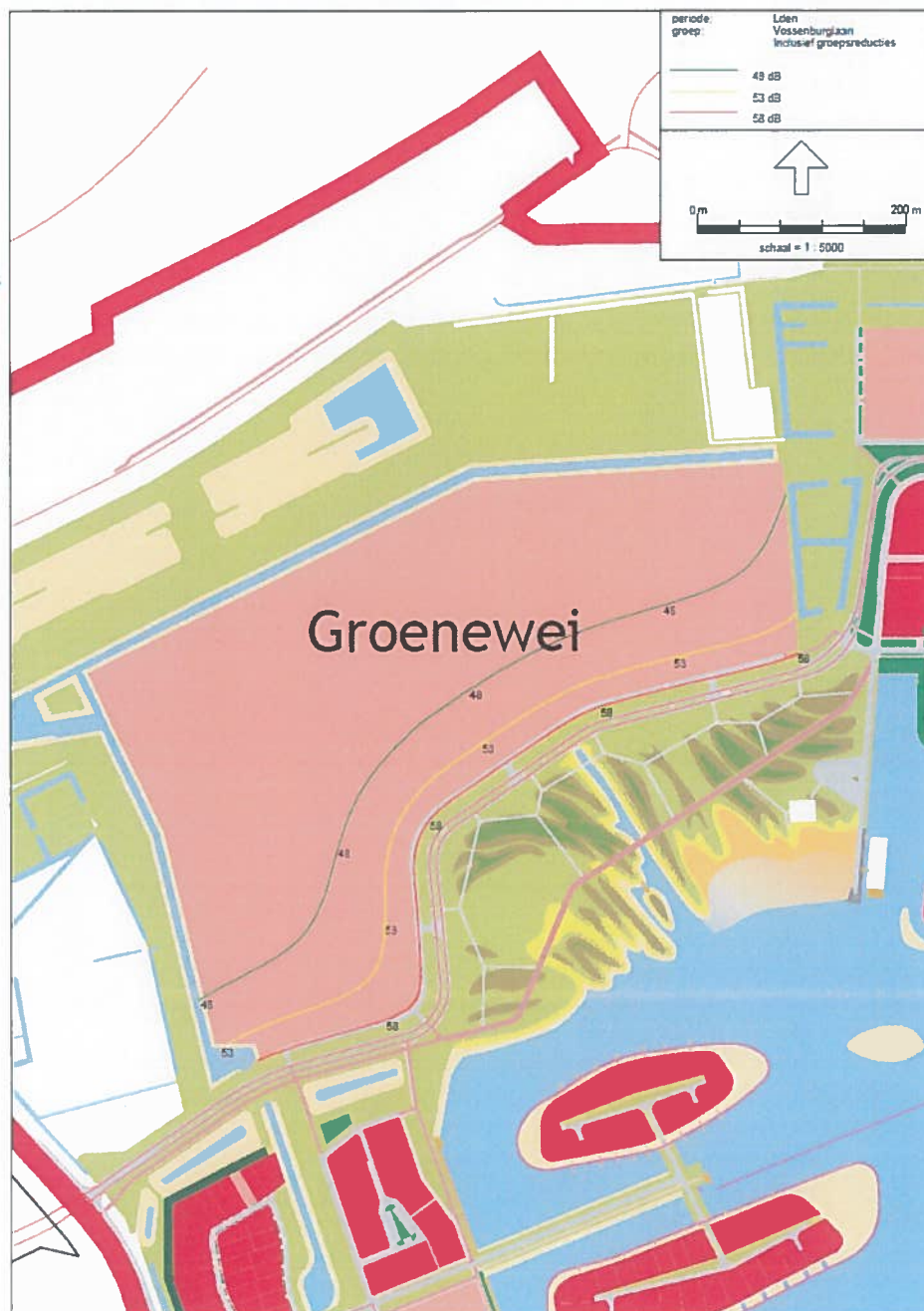
Geluidszones Hoofdontsluitingsweg op 7,5 meter hoogte in L_{den} incl. aftrek van 5 dB conform de Wgh art. 110 g.
